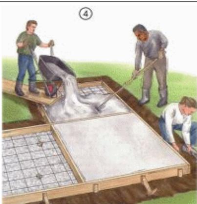
По границе участка предназначенного для заливки бетоном установите опалубку из досок толщиной не менее 40 мм, закрепив их кольями через каждые 60-100 см.
